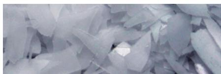
Las escamas de hielo se generan congelando una película de agua que cae continuamente sobre un cilindro de acero inoxidable con gas refrigerante a muy baja temperatura en su interior.
