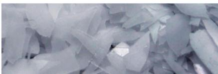
Las escamas de hielo se generan congelando una película de agua que cae continuamente sobre un cilindro de acero inoxidable con gas refrigerante a muy baja temperatura en su interior.
